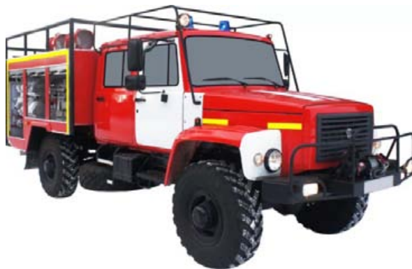
Рисунок 6. Пожарная автоцистерна АЦ-1,6-40 на шасси ГАЗ-33081 «Садко»
