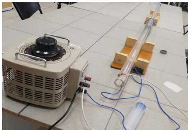
Рисунок . Лабораторная установка по изучению процессов горения в трубопроводе
