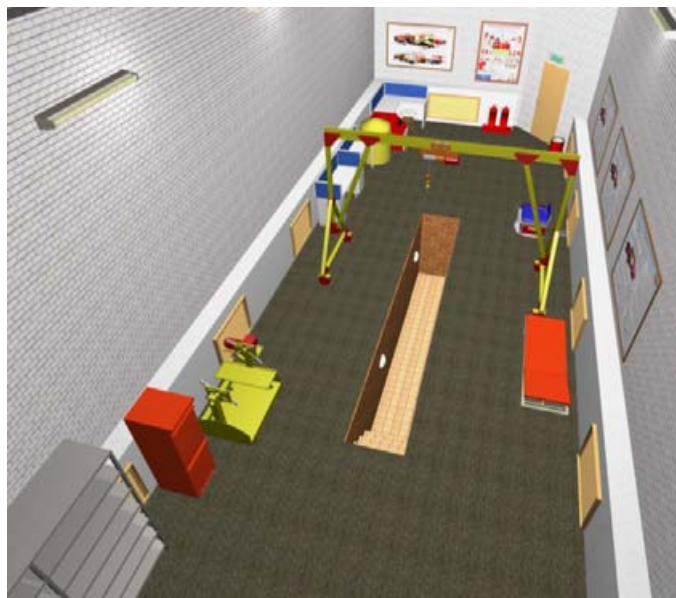
Рисунок 2. Помещение поста технического обслуживания пожарной техники
